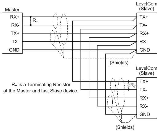
**Figure 16 5 wire RS-485 wiring**
