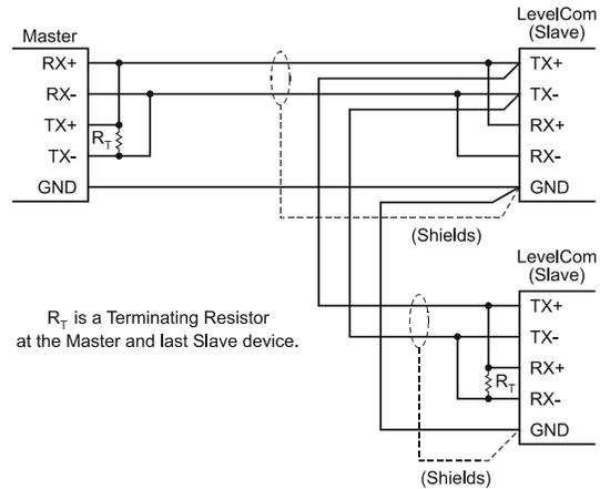
**Figure 17 3 wire RS-485 wiring**
